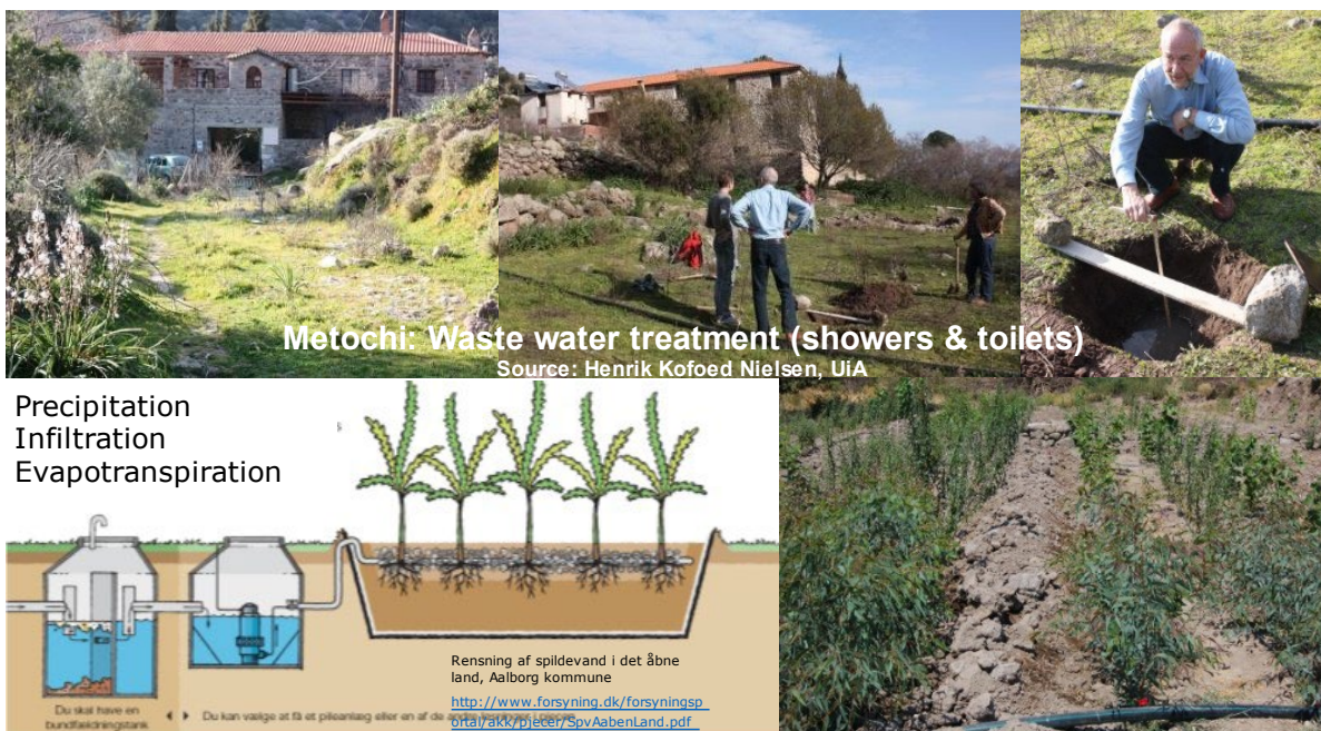
Figur 1: Bilder og en illustrasjon av rensesystem for spillvann implementert ved Metochi. Kilde: Henrik Kofoed Nielsen, UiA.
